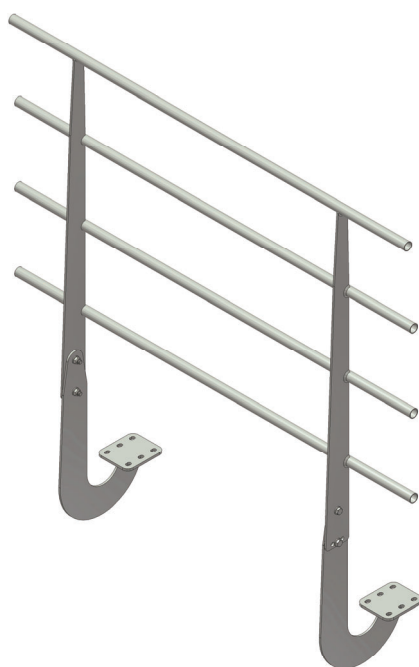
Figura 5.2.3-1 Esempio di parapetto permanente sottogronda
